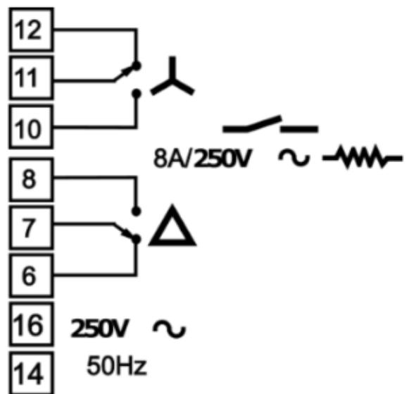
Vreme T1: podešavanje trimerom na čeonoj ploči Vreme T2: 100ms Napon napajanja Un: 250VAC, (+10%, -10%) Izlaz: 8A/250V Temperaturni opseg: 0 - +55C Tačnost podeoka na skali: <10% Potrošnja: <1.8W Potenciometrom se podešava tačno vreme koje potrebno korisniku da se iz vremena T1 "rele zvezda" priključi rele "trougao"
